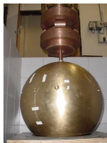
Detector Mário Schenberg na USP: 65 cm diâmetro, 1.2 ton
