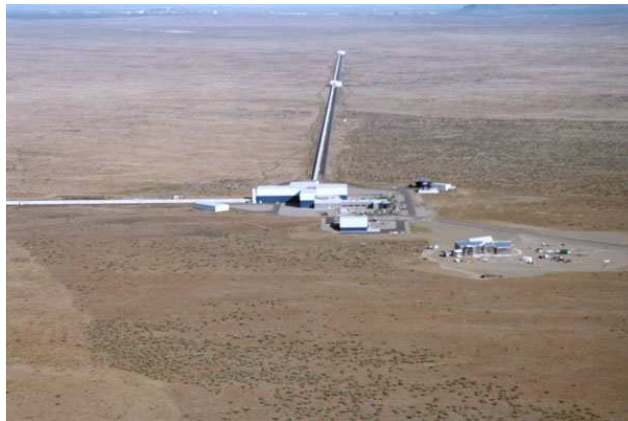
LIGO: detector de ondas gravitacionais (interferometria com laser) 4 Km
