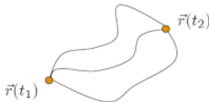
Figura 1: Possíveis caminhos entre dois pontos fixados. A(s) trajetória(s) realizada(s), em mecânica clássica, é/são a(s) que extremiza(m) a ação.
