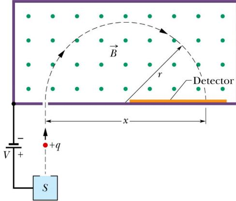
*Espectrômetro de massa:* Medindo o raio  $r = x/2$ , podemos medir a razão massa/carga da partícula:
