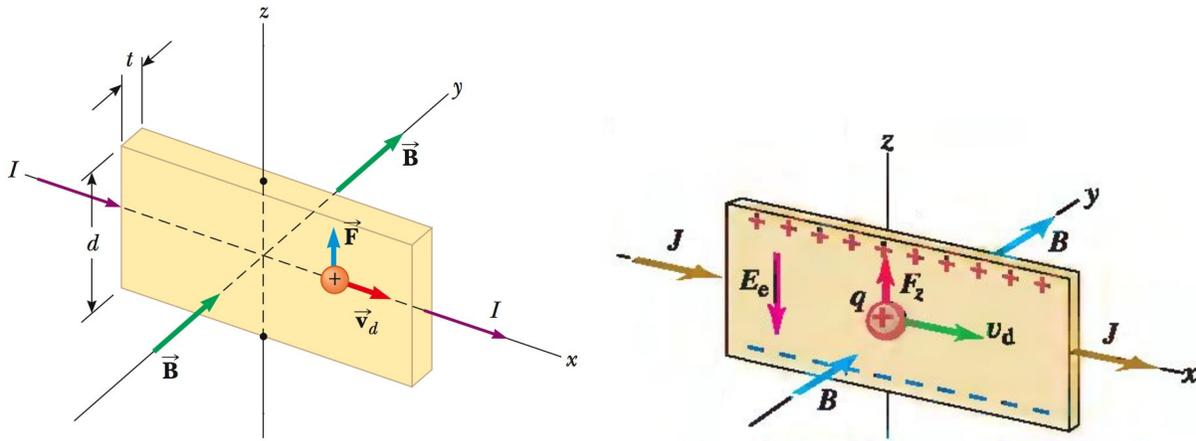
Figura 6.6: Efeito Hall. Uma corrente passa na placa de metal sob a ação de um campo  $\vec{B}$  na direção  $y$ , e cargas sofrem força magnética  $F_B$  na direção  $z$ , desviando-se nesta direção (Halliday). À medida que estas cargas se acumulam nas partes superiores da placa metálica, um campo elétrico é criado, produzindo uma força elétrica  $F_E$ . No equilíbrio,  $F_e = F_B$ . Se os portadores de carga forem negativos, a diferença de potencial criada tem sinal oposto. (Serway)
